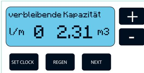
Bei dieser Anzeige wird Ihnen die restliche Kapazität angezeigt (in Kubikmetern).
